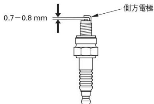
6. 取付けはまず手で一杯までねじ込み、次に同梱の専用プラグレンチで確実に締付けます。
