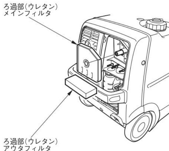
3. ろ過部(ウレタン)は洗い油または中性洗剤を水で薄めて洗い、よく絞って乾かします。オイルに浸した後、固く絞ってから取付けます。
