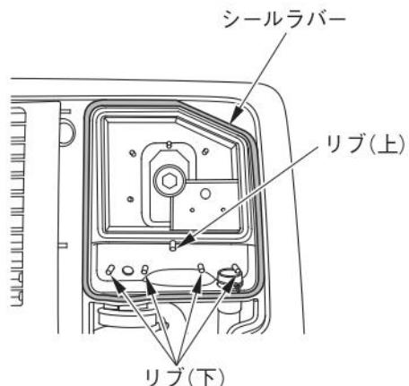
3. 本機側のシールラバーに損傷がないこと、また確実に取付けられていることを確認します。
